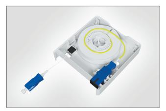
Vista interna del kit de extensión de fibra con bobina, adaptador SC SX y
