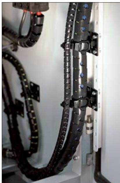
HWPP es ideal para aplicaciones en las que se requiere una alta flexibilidad, por ejemplo, en cableado de puertas.
