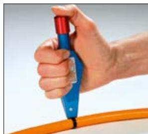
... presione hacia abajo el cabezal de color, sin dejar de apretar suavemente la brida...
