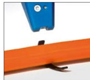
... deje de presionar el cabezal y levante la herramienta. La brida está cortada y lista para ser quitada.
