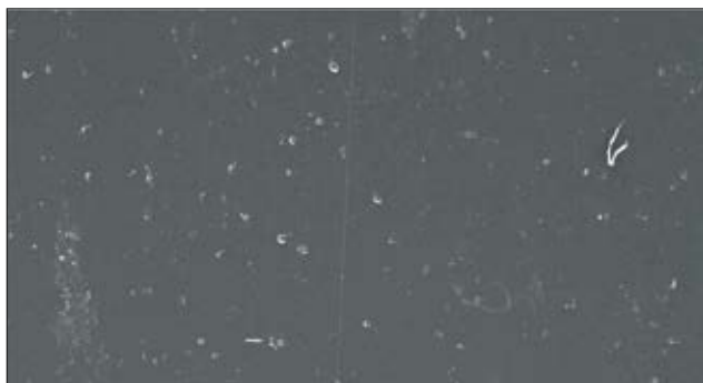
Muestra dañada en puntos aislados por la radiación UV.
