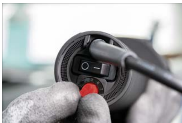
Regulador de temperatura en H6100.
