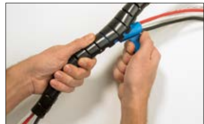
Deslice el aplicador HAT a través del cuerpo del Helawrap.
