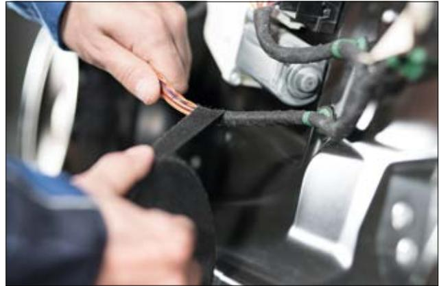
*HelaTape Protect 250 está diseñada para cablear y ofrece una muy alta resistencia a la temperatura.*
